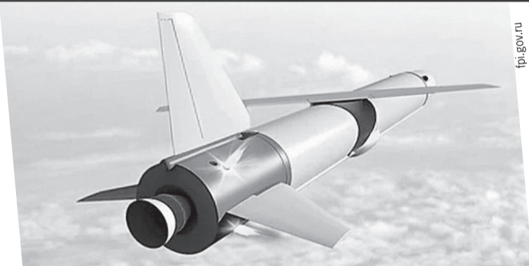
Многоразовая ракета «Крыло-СВ», по планам, должна приземляться не вертикально, а как самолет.
