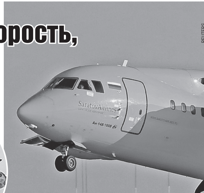
Так выглядит датчик скорости на носу лайнера, который мог отказать из-за обледенения.
