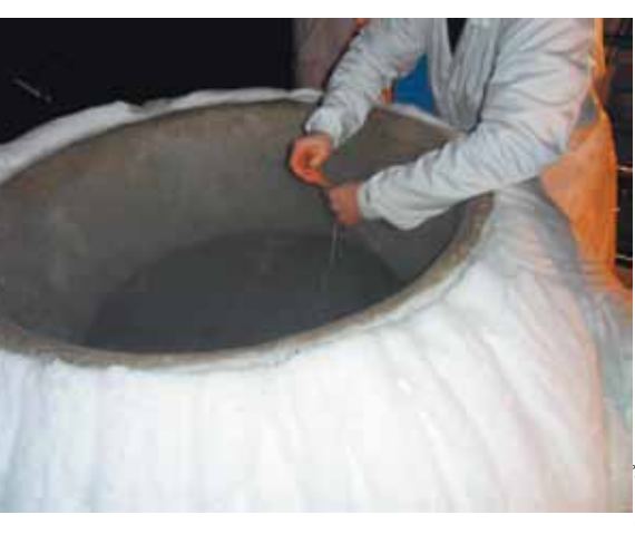
В таких дьюарах хранят криопацентов при температуре -196 градусов по Цельсию.
