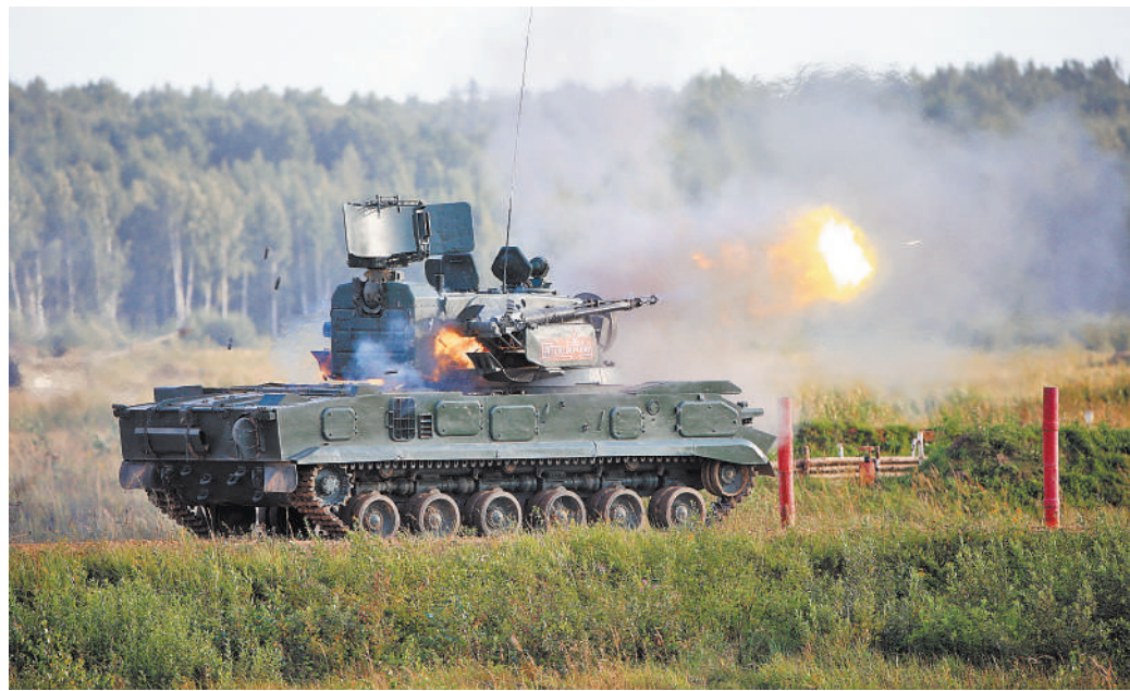
Зенитный ракетно-пушечный комплекс «Тунгуска-М1» ведет ураганный огонь по низколетящей цели сразу из четырех 30-мм стволов спаренных автоматических пушек 2А38.
