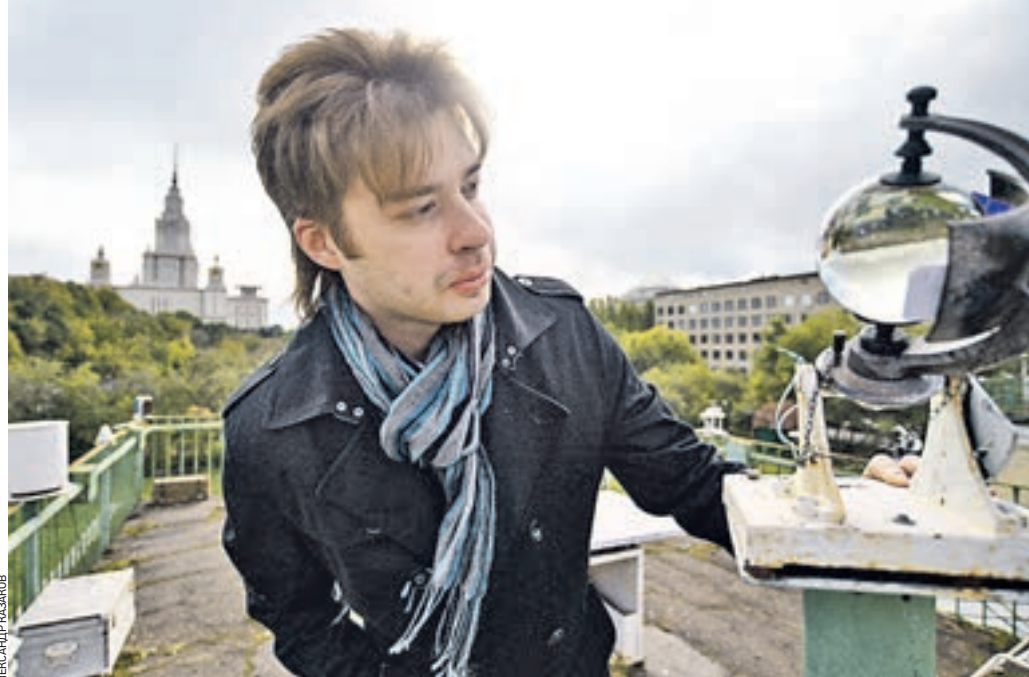
Вчера 15:00 Необычный стеклянный шар, в котором отражается небо и главное здание МГУ. — метеорологический прибор гелиограф. Метеоролог Павел Константинов снимает с него показания
