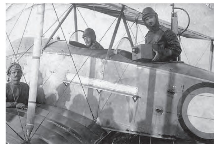
Аэрофотоосъемка получила бурное развитие с появлением самолетов. На фото летчик-наблюдатель с аэрофотоаппаратом
